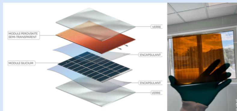
Schéma de principe et photo d'un module tandem développé dans le cadre du programme STaFF (Souveraineté industrielle Tandem de Fabrication Française).
