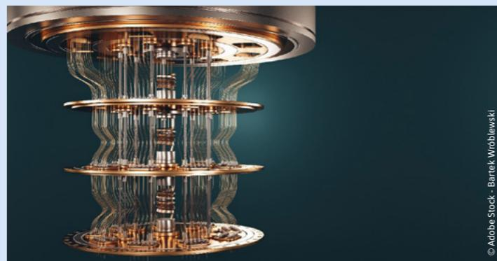
Les qubit d'un ordinateur quantique fonctionnent à ultra basse température, dans un cryostat.
