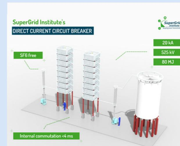
Le disjoncteur 525 kV DC innovant développé par SuperGrid Institute.
