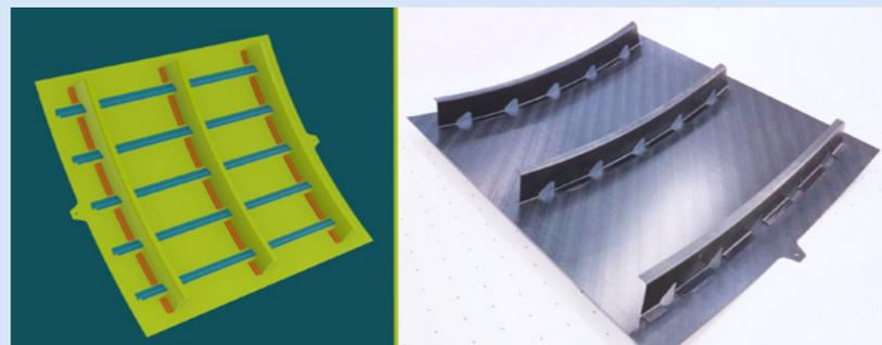
Assemblage composite thermoplastique des cadres sur le panneau de fuselage réalisé par soudage par conduction.
