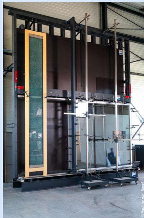
Banc d'essais Air-Eau-Vent pour éléments de façades.
